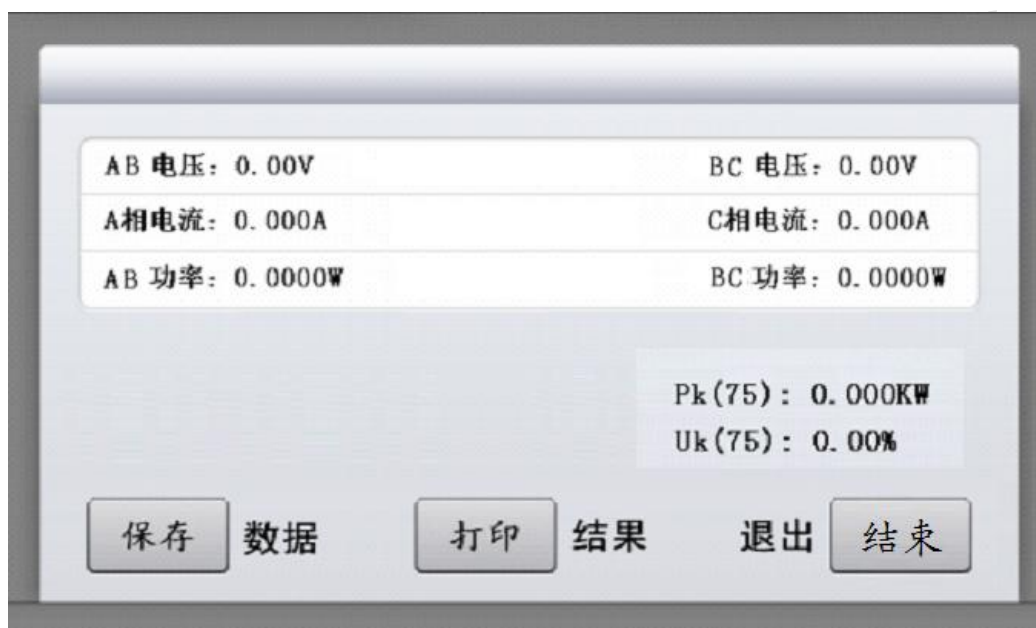
图十一 两元件法负载测试
