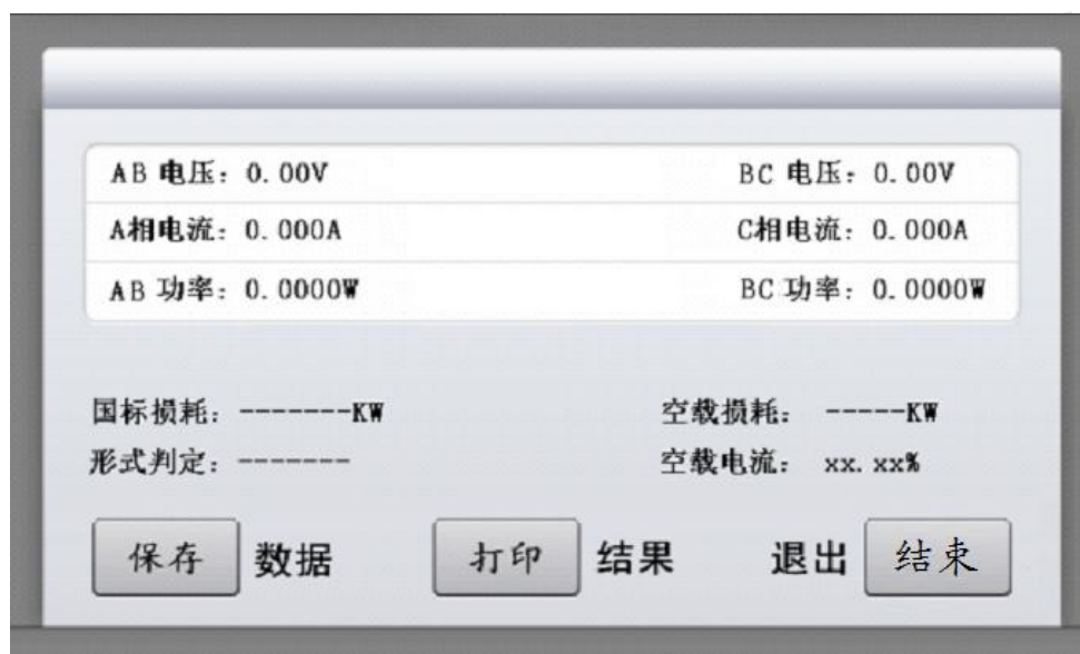
图七 两元件法空载测试
