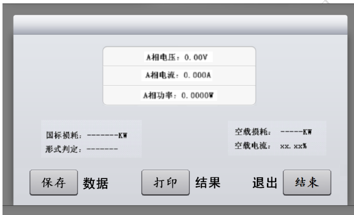
图八 单相空载测试
